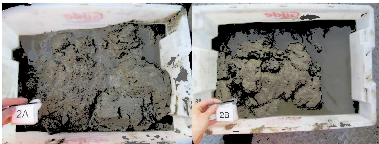
Figur V9.7 Sediment før vask ved NGÅ-REF, hvor 2A indikerer første hugg og 2B andre hugg.
